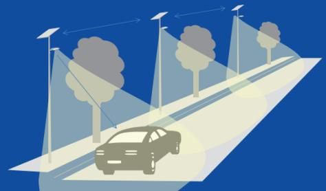
Le mât à l'origine d'une **détection de mouvement** propage cette information par radio sur **une centaine de mètres**, déclenchant l'allumage d'une «**zone de sécurité**» autour de l'**objet** en mouvement. La propagation radio permet en cas de batterie faible **d'abaisser fortement l'éclairage** hors détection de mouvement, tout en assurant la **sécurité des usagers** dès le déclenchement de la détection.
