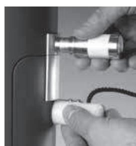
Insérez le crochet dans la fente en le déplaçant sur la droite.
