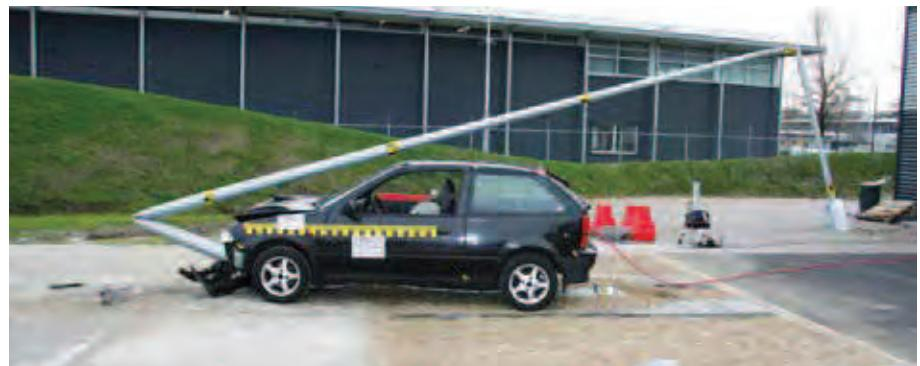
peuvent être employés au bord de voies de vitesse de référence inférieure ou égale à 70 km/h. A forte absorption d'énergie (classe HE), ils sont particulièrement adaptés pour des routes ou voies où circulent de nombreux usagers vulnérables (2 roues, piétons) ou sur des voies surplombant d'autres voies ou équipements.
