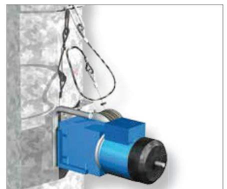
Manœuvre par treuil électrique
