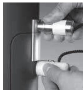
Appuyez la clé jusqu'en butée pour déclencher l'aimant.
